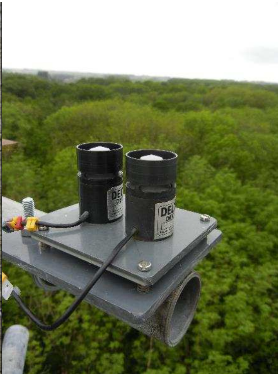
De dendrometer op een van de beuken meet hoeveel de boomstam krimpt en zwelt doorheen de dag. De solarimeter bovenop de meettoeren meet de zonnestraling. (foto's Sanne Van Den Berge)
