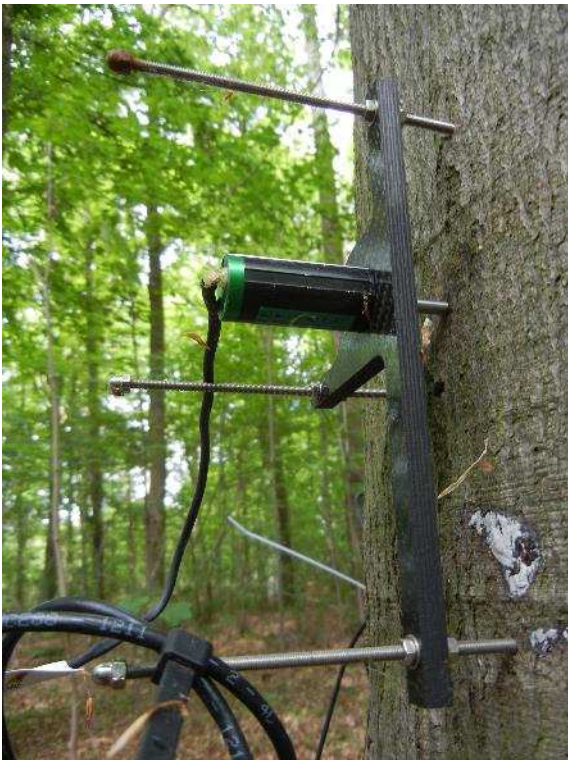
De dendrometer op een van de beuken meet hoeveel de boomstam krimpt en zwelt doorheen de dag. De solarimeter bovenop de meettoeren meet de zonnestraling. (foto's Sanne Van Den Berge)
